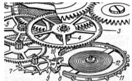
Autovõngete tavanäide - kellamehhanism. Iga võnke järel annab kellavedru poolt veetav hammasratas (7) balansiirile (11) tõuke, mis kompenseerib hõõrdumisel kaotsi läinud energia.
